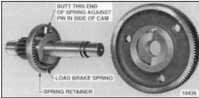
LOAD BRAKE — OVERLOAD CLUTCH
